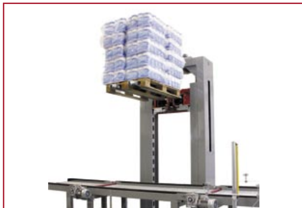
SOLLEVATORE PALLETS IN AVVOLGIMENTO PALLETS LIFTING DEVICE IN WRAPPING AREA
